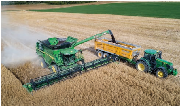
Mähdrescher mit 13,7 m Arbeitsbreite Bild: Hansjörg Honold
