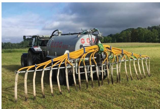
Güllefass mit Schleppschlauch Bild: Hansjörg Honold
